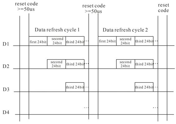
注: 其中 D1 为 MCU 端发送的数据, D2、D3、D4 为级联电路自动整形转发的数据。
